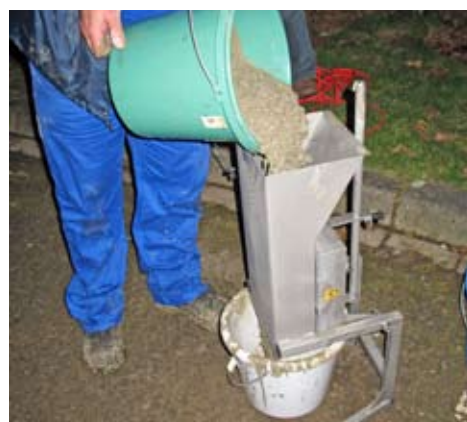
Dozometr do sprawdzania ilości włókien w świeżym betonie
