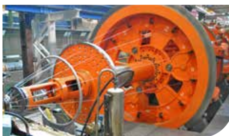
Opération de câblage
