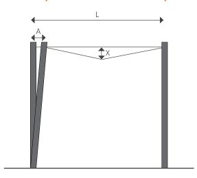
Bien vérifier la solidité et la tenue des ancrages. Pour une longueur  $\bf L$  de 100 m, si le piquet de tête bouge de seulement  $\bf A=2$  cm, alors le fil aura une flèche due à la perte de tension de  $\bf X=1$  m! Spectaculaire!
