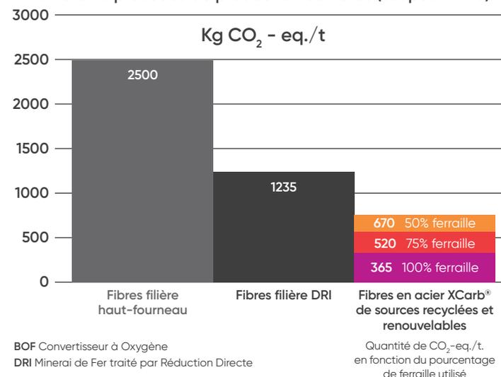
Les fibres en acier XCarb® de sources recyclées et renouvelables peuvent diminuer jusqu'à 85% le volume de CO<sub>2</sub> émis par rapport à des fibres standards.
