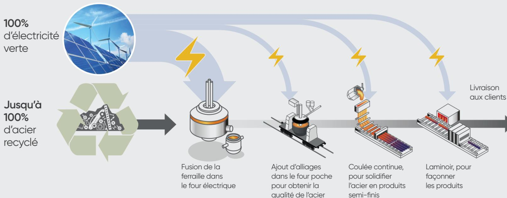
Toute l'électricité nécessaire à la transformation de la ferraille en acier XCarb® de sources recyclées et renouvelables provient de sources renouvelables telles que l'énergie solaire et éolienne.
