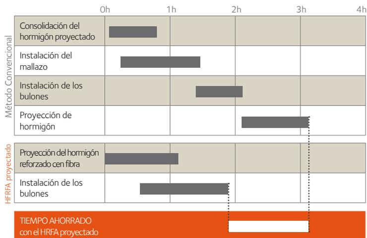
Método convencional comparado con el método del HFRA proyectado.
