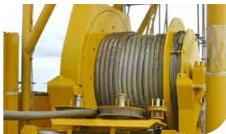
Notor HP Durchmesser 102 mm Bruchlast 9320 kN
