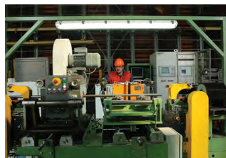
Contrôle hors ligne par Courants de Foucault et ultrasons.
